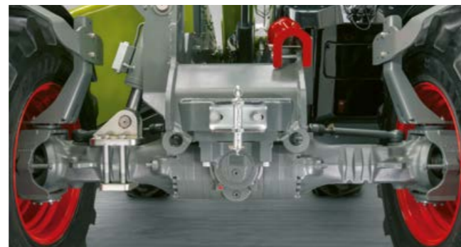
Châssis avec compensation de dévers hydraulique.
